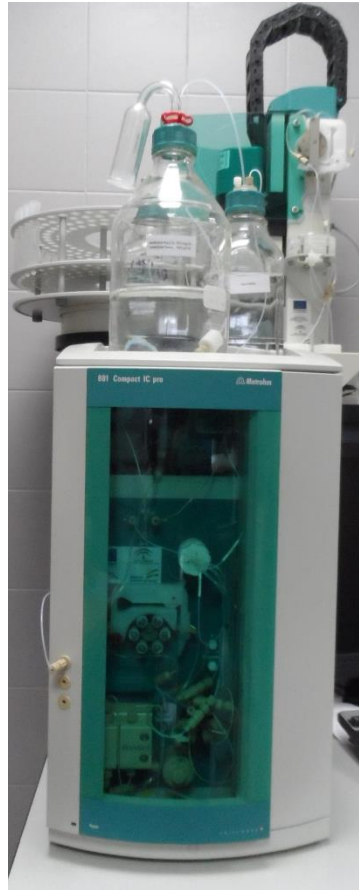
Figura 3.7. Cromatógrafo iónico utilizado para la determinación de la concentración de aniones del efluente de secundario de la EDAR.
