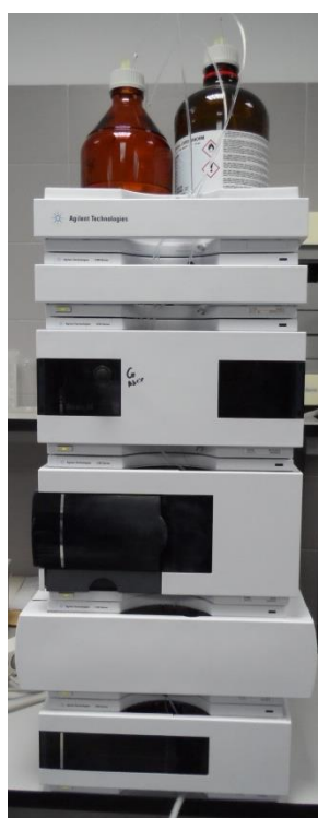
Figura 3.6. Equipo de cromatografía líquida de ultra-alta resolución utilizado para el seguimiento de la concentración de resorcinol.
